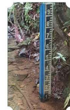
Linnimetro para medir nivel de agua, fuentes de agua la gallego, vizcaína y fsn 4, vereda el molino, requisito cornare
