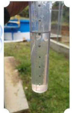
Pluviómetro para medir lluvias, en ptap vereda el molino, requisito cornare
