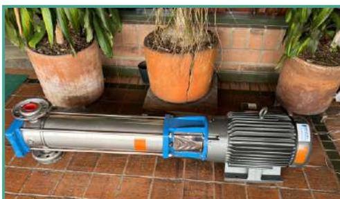
Motobomba de 50 hp instalada para bombear agua a tanque la chorrera, interconexión con sistema Acueducto Canoas
